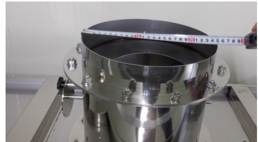
ダクト部 口径約Φ250mm
